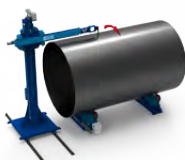
Wykonywanie spoin obwodowych zewnętrznych, spawany element jest obracany przez obrotnik rolkowy MOST, możliwość spawania kołnierzy.
