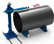
Wykonywanie spoin wzdłużnych, możliwość wykonywania spoiny wewnętrznej i zewnętrznej. Np. przy produkcji zbiorników.
