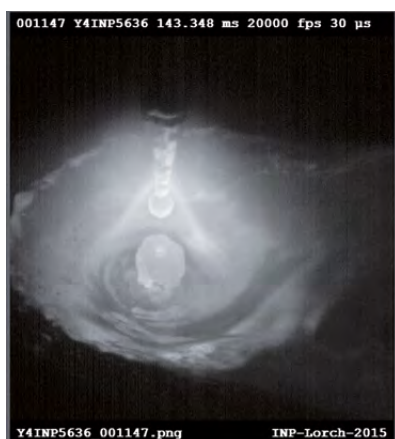
Kropla pierwotna oddziela się i tworzą się krople wtórne.
