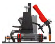
Spawanie połączeń doczołowych
