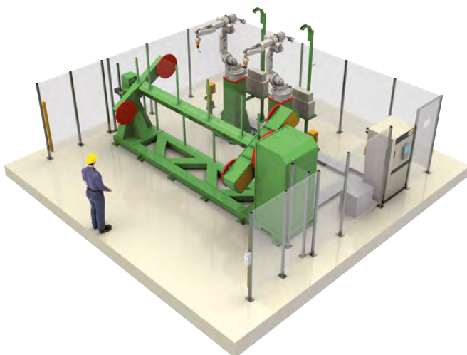
Cela zrobotyzowana z dwoma robotami i obrotnikiem dwustanowiskowym 0-180° (każde stanowisko ze sterowaną osią poziomą).
