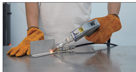
Głowica spawalnicza - "pistolet" z przewodnikiem drutu
