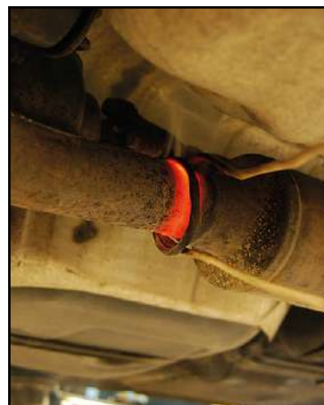
Podgrzewanie rury tłumika - cewka elastyczna
