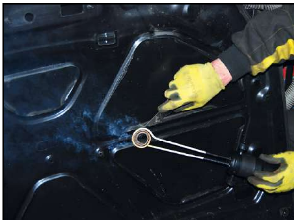
Usuwanie uszczelek - cewka PAD
