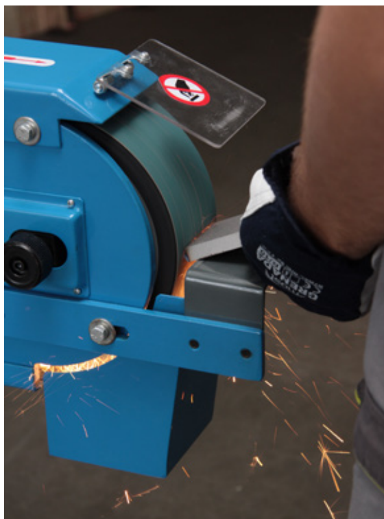
Szlifowanie na kole kontaktowym.
