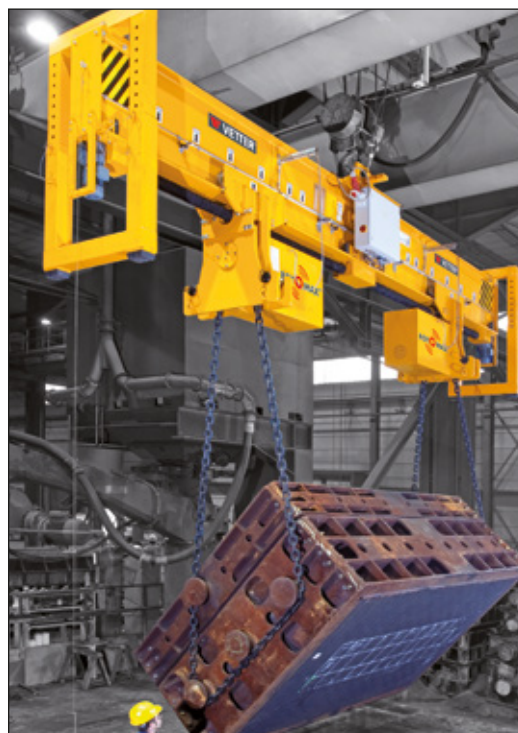
ROTOMAX RE do pracy w tandemie z 2 żurawiami. Nośność: 3000 kg - 20000 kg
