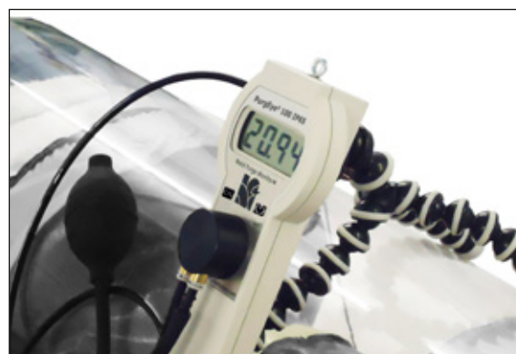
Możliwość umiejscowienia miernika na stanowisku spawalniczym
