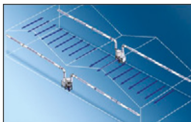
System równoległy z 2 filtrami i wentylatorami
