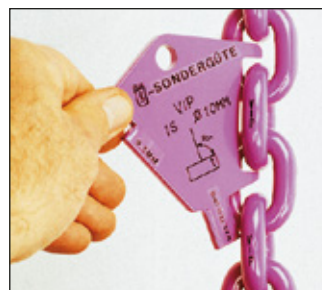
Kontrola długości na podstawie zużycia grubości ogniwa.
