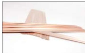
Die Kupfer-Phosphor-Legierungen werden häufig verwendet um Kupfer und Kupferlegierungen mit unedlen Metallen (Messing, Bronze) zu verbinden. Sie haben selbstfließende Eigenschaften bei der Verbindung mit Pasten und Pulvern. Ag15CuP ist verfügbar als Paste und Pulver, sowie als Streifen. Kupfer-Phosphor-Legierungen sollten nicht auf Eisen- oder Nickel-Legierungen verwendet werden.
