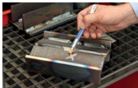
Markierung des zu behandelnden Elements (in diesem Fall 100^{\circ}\text{C} )
