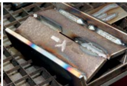
Farbänderung des markierten Elements nach Erreichen der angegebenen Temperatur
