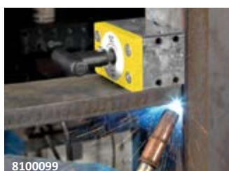
Schnelle Herstellung von 90 Grad Winkeln
