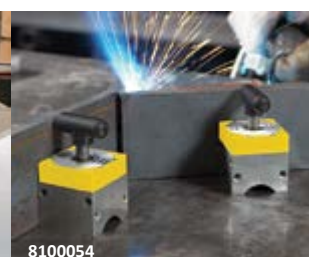
Winkel schnell herstellbar, die Ecken können zusammengezogen werden mit Halt auf mehreren Seiten
