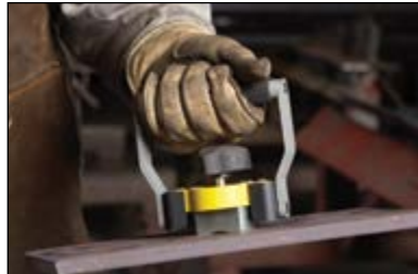
Handheber für alle kleinen Stahlteile
