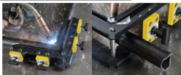
Zusätzliche MAGSQUARES auf jeder Achse für extra Haltekraft
