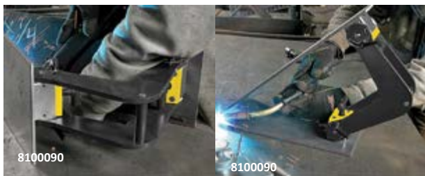
Einstellwinkel für das schnelle und präzise Einstellen der Position
