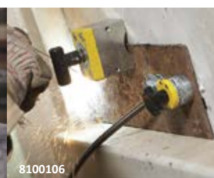
Helfende Hand – temporäre Unterstüzung um ein Teil oder Werkzeug an einer senkrechten Wand zu halten
