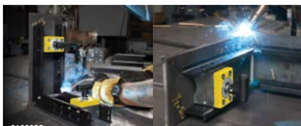
MAGSQUARES können auf jeder Achse neu positioniert oder umgekehrt werden
